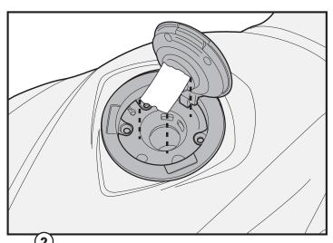
. PRIMA DI PROCEDERE APPLICARE DELLO SCOTCH SUL FORO DEL SERBATOIO PER EVITARE DI PERDERE DELLE VITI.
