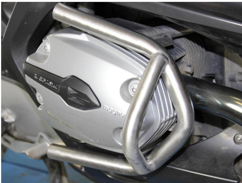
Sturzbügel montiert an einer
