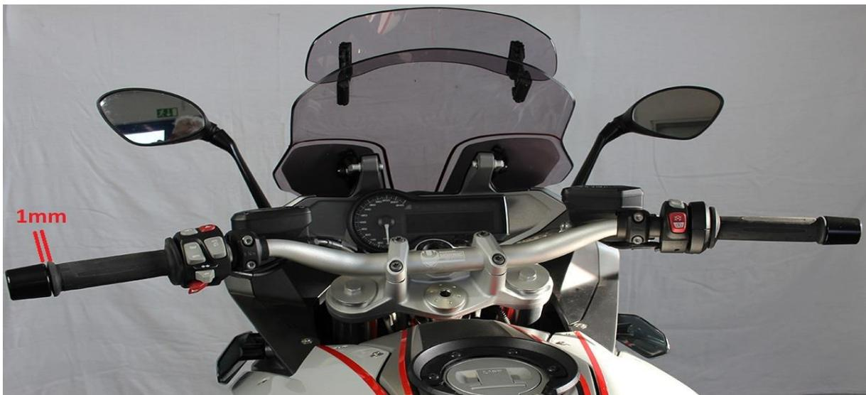
Montage des Rohrlenkers mit den Klemmböcken auf der Gabelbrücke. Die Schrauben des Original-Stummellenkers werden für die Montage der Klemmblöcke verwendet (M8x35 19 Nm). Kupplungs- und Bremsarmatur werden so montiert, dass diese 15mm über das Lenkerende hinausstehen. So bleibt ein Spalt (1mm) zwischen Lenkergewicht und Griffgummi. Die Lenkerbreite entspricht so 810mm. Kupplungs- und Bremsarmatur werden mit 8Nm angezogen. Einzelheiten siehe Video.
