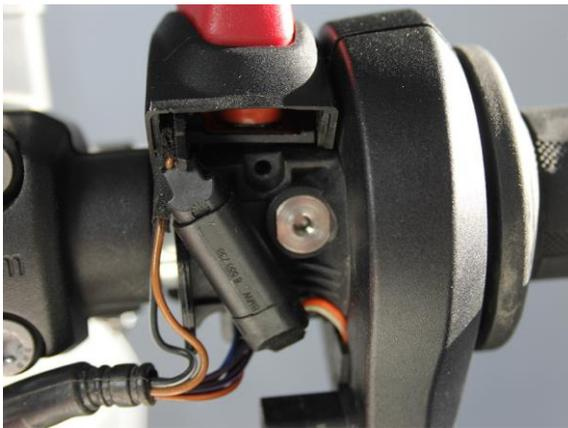
Ist die korrekte Stellung der Handarmaturen gefunden, müssen diese verschraubt werden. Bohrung markieren (anbohren). Um sicher zu gehen, dass die Bohrung mittig auf dem Lenker sitzt (Durchmesser 4mm) , empfehlen wir den Lenker nochmal zu demontieren und auf einer Ständerbohrmaschine die Bohrung für Kupplungs- und Bremsarmatur zu machen.
