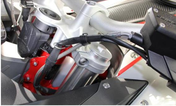
Bei Bedarf Stahlflexleitung aus dem Haltebügel herausnehmen.
