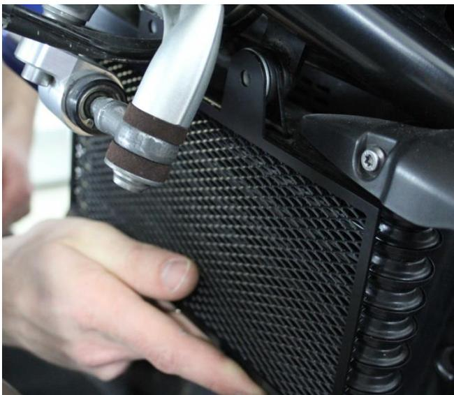
3. Kühlergitter unten einhängen und oben mit den 2 originalen Schrauben wieder festschrauben.
